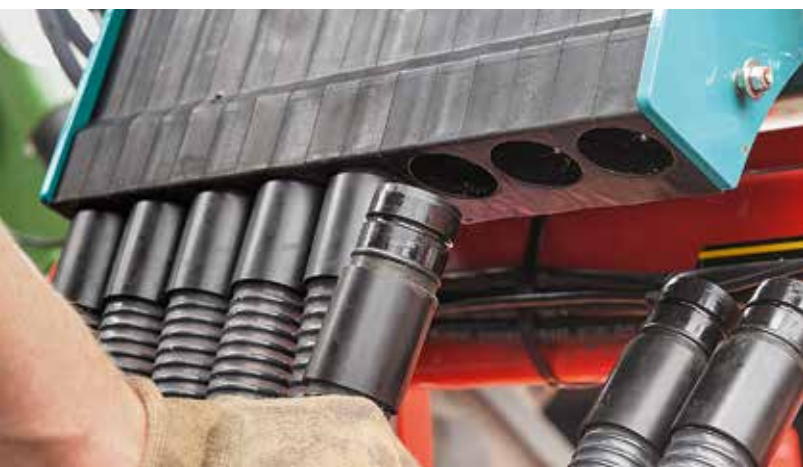
◁ Zum Abdrehen muss man die Saatschläuche abziehen. Dazu sollte unter dem Streuer genügend Platz sein.
