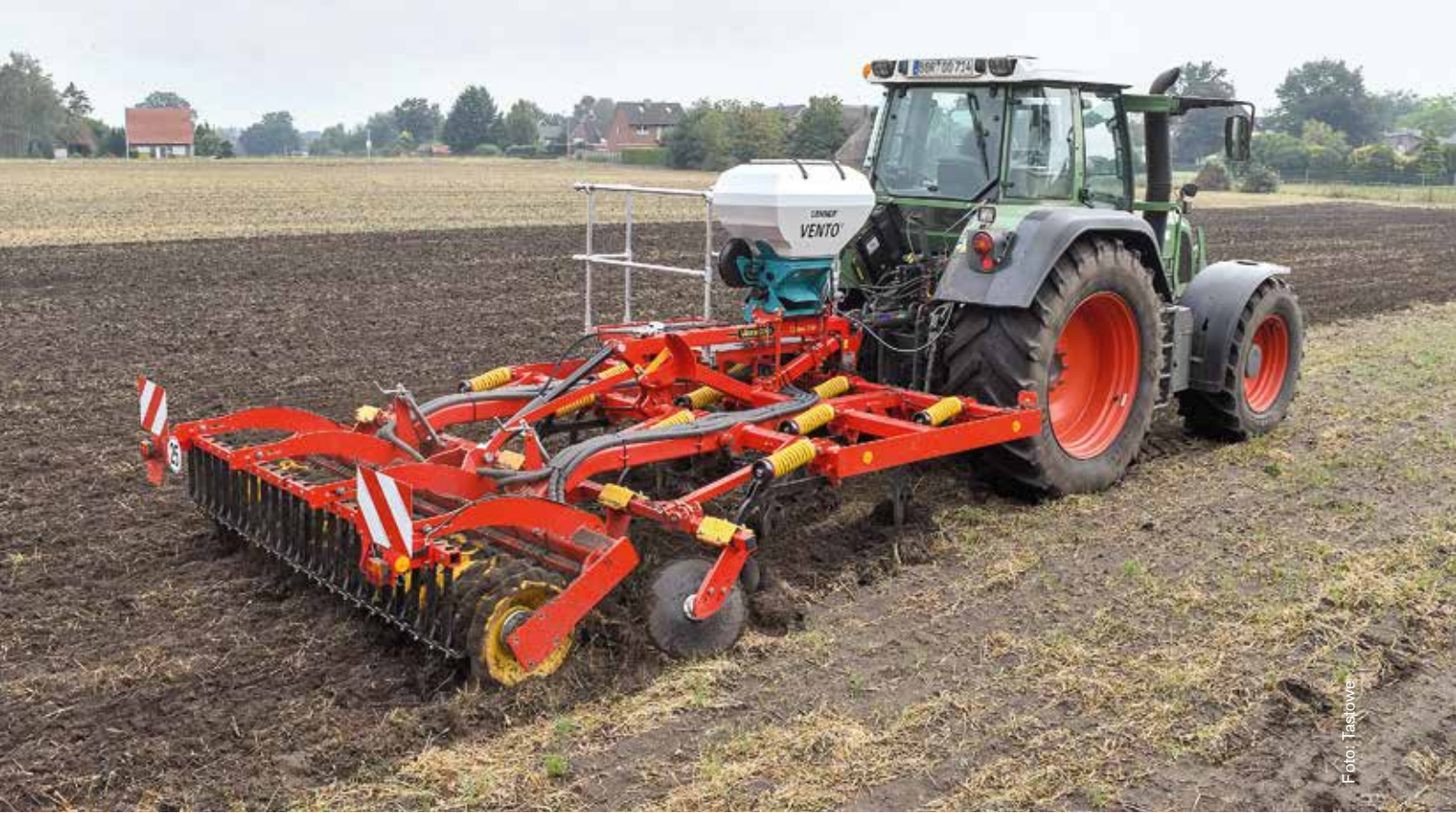
△ Wir haben den Lechner Vento unter anderem zur Zwischenfrucht-saat nach Getreide eingesetzt. Die Querverteilung war im Test gut.
