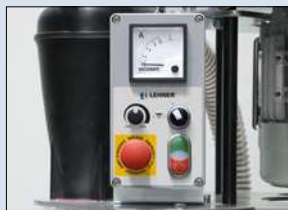
Steuereinheit des SpeltEx® Pro: wie SpeltEx®, jedoch stufenlose Feineinstellung der Dosiermenge mithilfe der Zellenradwellen-Drehzahl.
