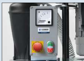
Steuereinheit des SpeltEx® mit An/Aus, Not-Aus und Amperemeter.
