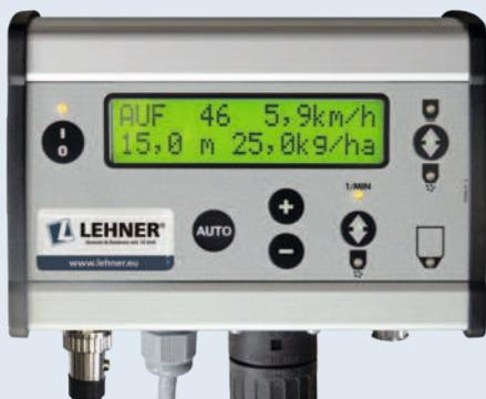
В меню системы управления AUTO-DOSIS производителем уже внесены 12 таблиц для определения оптимального диапазона разбрасывания рабочего материала. В случае необходимости производитель может установить таблицы с рабочими параметрами для других материалов. Обзор имеющихся таблиц вы можете найти в разделе «Загрузка» на нашем сайте [www.lehner.eu](http://www.lehner.eu)
