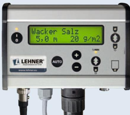
В меню системы управления AUTO-DOSIS производителем уже внесены таблицы для определения оптимального диапазона разбрасывания рабочего материала. В случае необходимости производитель может установить таблицы с рабочими параметрами для других материалов (если такие имеются).
