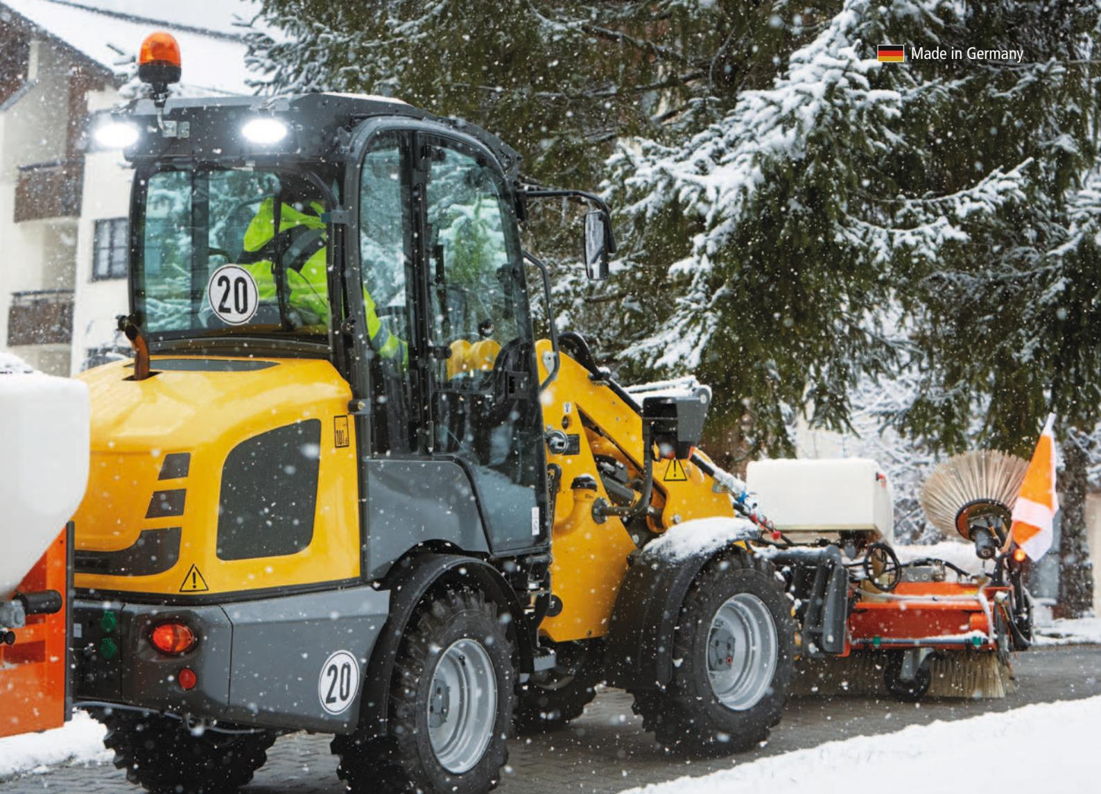
► Отличное обслуживание дорог в зимнее время: колесный погрузчик с разбрасывателем POLARO® со складным креплением на тяговой вилке
