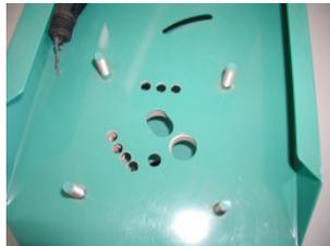
5. An allen 4 Ecken je eine U-Scheibe aus bestehendem Schieber einbauen und neues Schließblech einbauen. Verbindungshaken von Schiebermotor am Schließblech einhängen.
