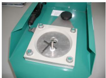
10. Am Streurrücken soll zwischen Oberseite Stahlrahmen und Behälterwinkel ein Abstand von ca. 2 mm sein. Dadurch wird dem Behälter beim Festziehen der Rändelmuttern etwas Vorspannung gegeben. Evt. Schrauben lösen, Löcher im Behälter nach oben etwas nachfeilen und wieder zusammenbauen.
