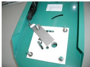
6. Obere Kunststoffplatte gemäß nachstehendem Bild einbauen und wieder 4 Scheiben aus altem Schieber auf die Platte legen.
