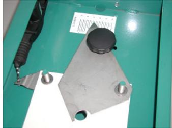
9. Zweimillimeter Edelstahlabdeckplatte aus altem Schieber einbauen, Kunststoffbehälteraufnahme aus alter Schiebereinheit einbauen und Schrauben wieder anziehen. Neue Rührwelle mit Dichtscheibe einbauen. Funktionskontrolle durchführen.
