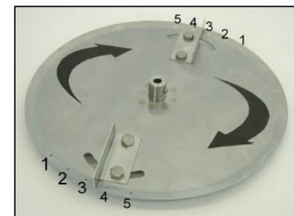
**Rührwerk: Oberer Rührfinger nicht einbauen. Unterer Rührfinger mittig ggf. sogar kürzen.**
