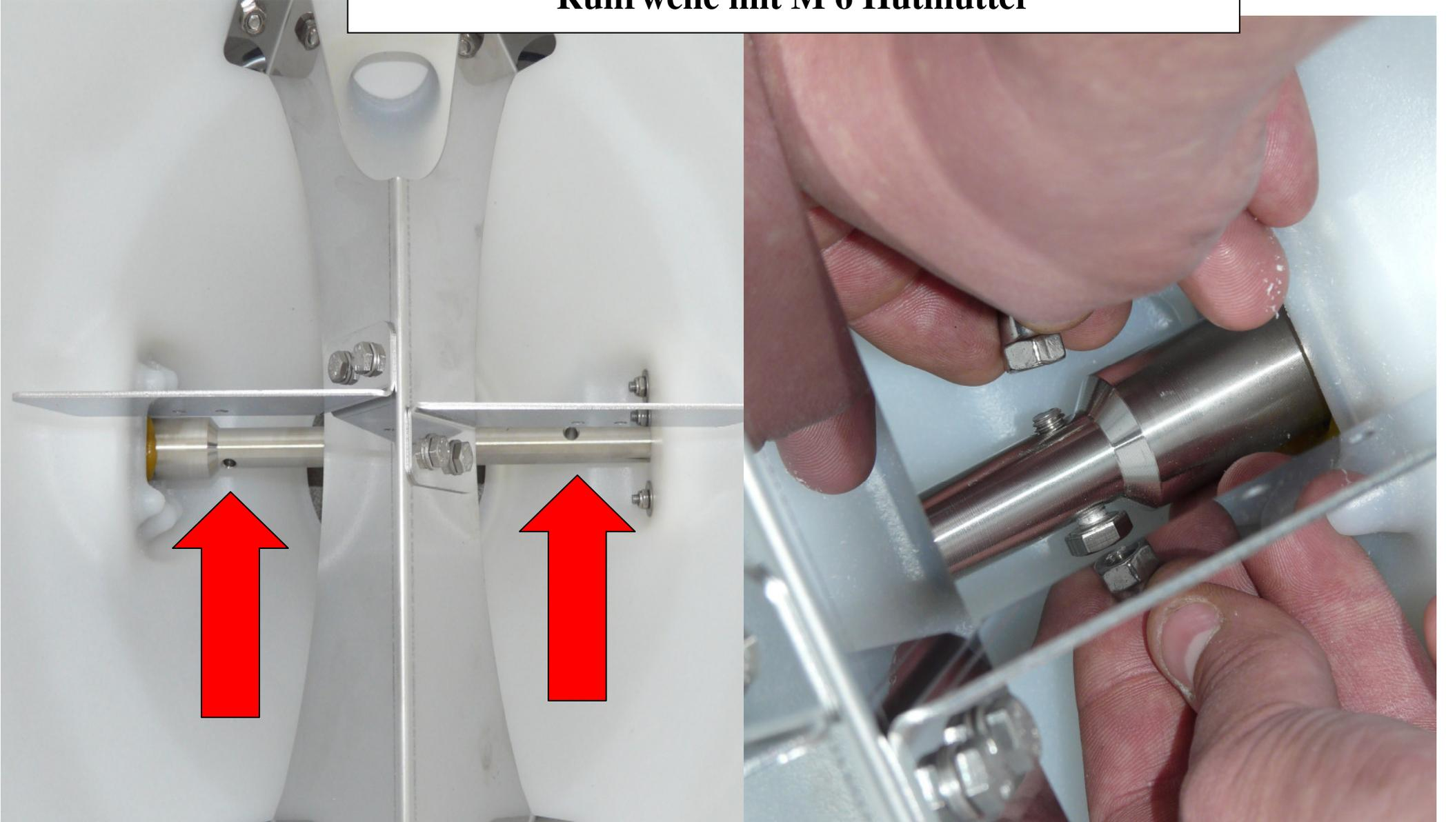
Die M6x25 Schraube durch die Rührwelle, an den rot markierten Löchern einführen und mit der M6 Hutmutter verschrauben.
