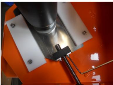
Lösen Sie nun beide Schrauben am schwarzen Block. Bitte nicht komplett ausschrauben, nur lösen.
