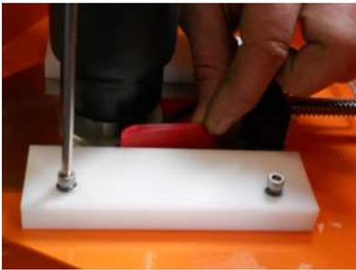
Lösen Sie beide Schrauben (siehe Bild) auf der weißen PET Platte. Entfernen Sie anschließend den rot markierten Metallwinkel. Beide Schrauben wieder fixieren, nach dem der Metallwinkel entfernt wurde.
