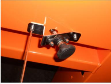
Beigefügte Schrauben 5x12 einschrauben und fest fixieren.
