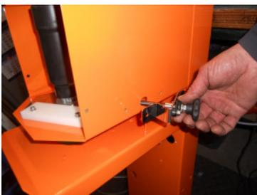
Nun die Bewegungsspindel in die Rahmenöffnung seitlich einführen. Bitte beachten Sie die Richtung des Metallwinkels auf der Abbildung.
