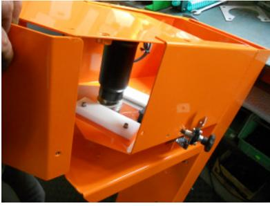
Stellen Sie Ihren POLARO E Streuer auf den Kopf. Entfernen Sie anschließend alle sechs Schrauben und ziehen Sie das Abdeckblech heraus. Nun haben Sie freie Sicht auf die Schieberführung sowie auf den Antriebsmotor.
