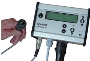
1. Steuerpultkabel mit der 7-poligen Signalsteckdose des Trägerfahrzeugs verbinden.
