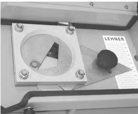
Bei Stellung 0 ist der Schieber nahezu geschlossen und bei Stellung 20 maximal geöffnet. In dem Bereich dazwischen ist die Schieberöffnung stufenlos einstellbar.
