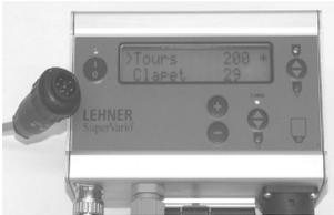
1. Verbindungskabel des Steuerpultes mit der 7-poligen Signalsteckdose des Trägerfahrzeugs verbinden.
